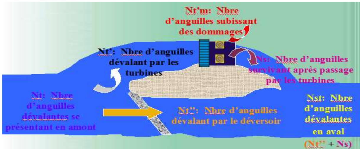
Figure 13 : Illustration du mode d'évaluation des mortalités d'anguilles au droit d'un aménagement hydroélectrique.
