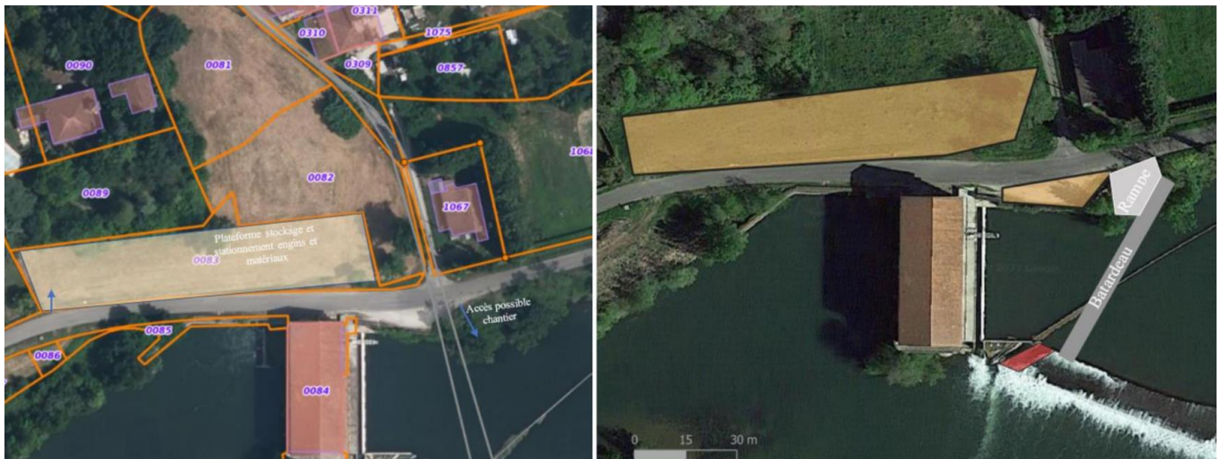
Illustration 8 : Accès et installation de chantier possibles pour la prise d'eau en rive droite
