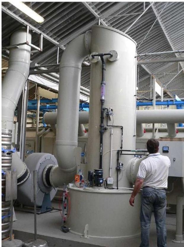
Figure 65 : photographie d'un laveur de gaz (source : Pickling Systems)
