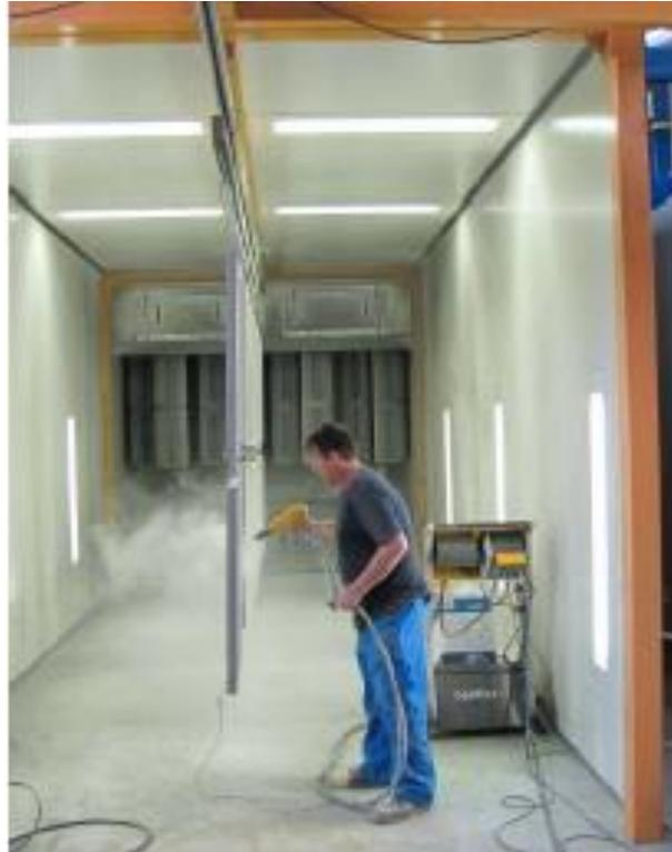
Figure 57 : photographie d'une opération de poudrage (source : REVETTECH)
