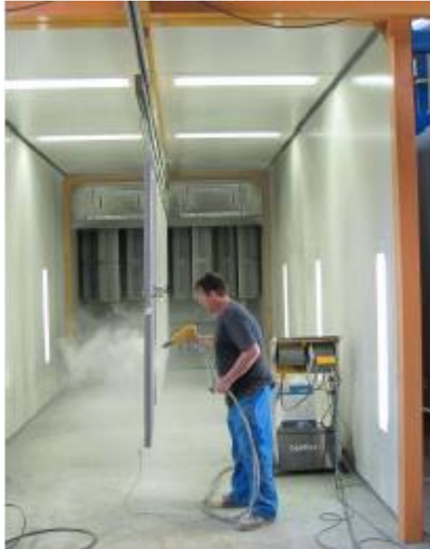
Figure 6 : photographie d'une opération de poudrage (source : REVETTECH)
