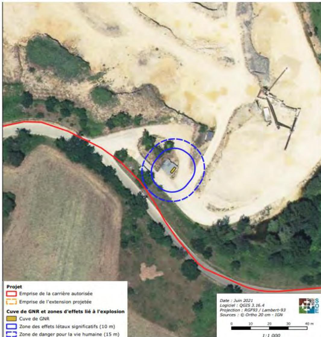
*Zones d'effet létaux autour de l'aire de dépotage et de la cuve de GNR lors d'un incendie du camion de ravitaillement – situation la plus défavorable.*
